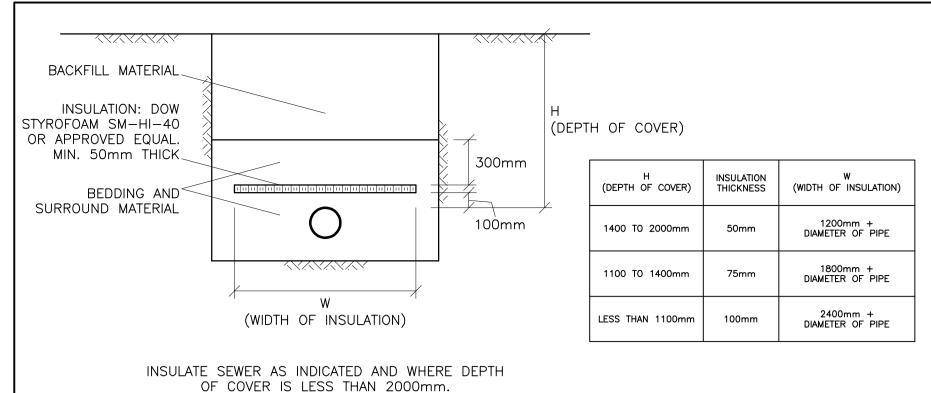
CENTER INSULATION OVER PIPE. JOINTS BETWEEN SHEETS OF INSULATION SHALL BE STAGGERED.
