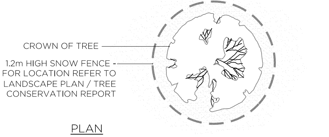
3 TREE PROTECTION FENCING N.T.S. L-02
