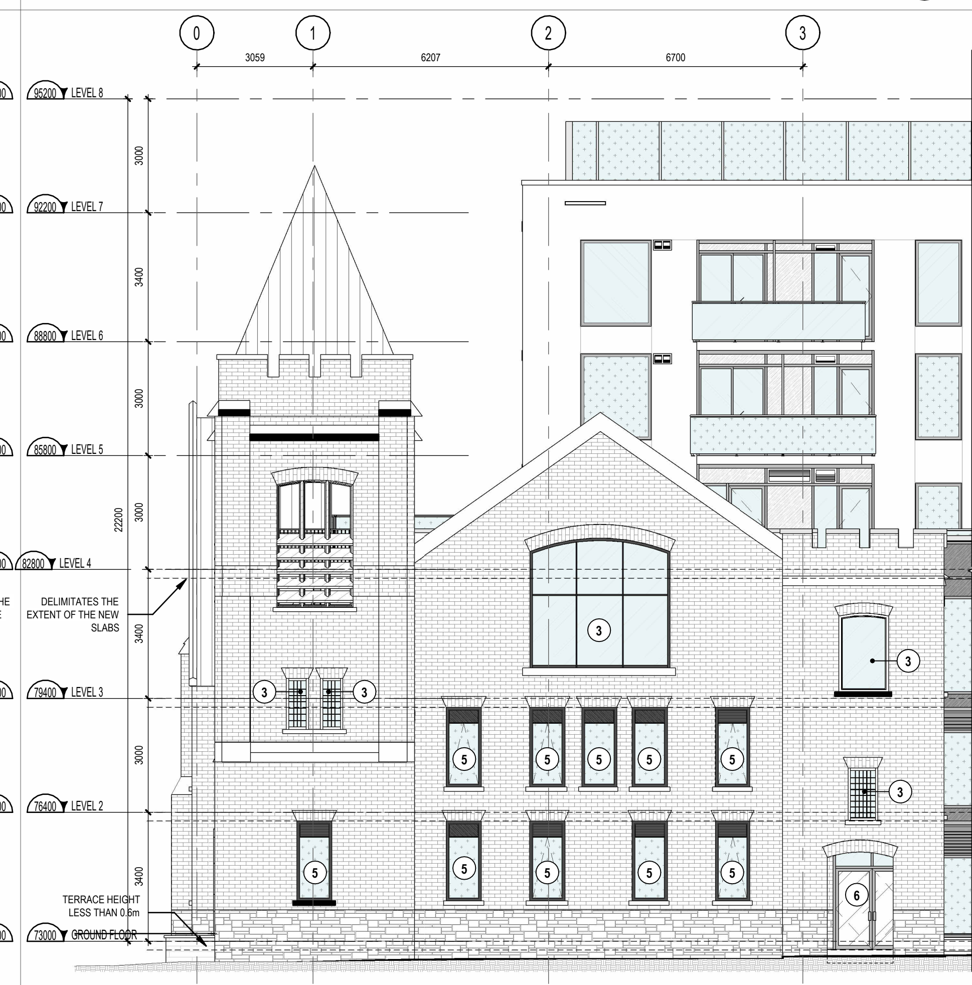
NEW WEST ELEVATION (BELL ST.)
