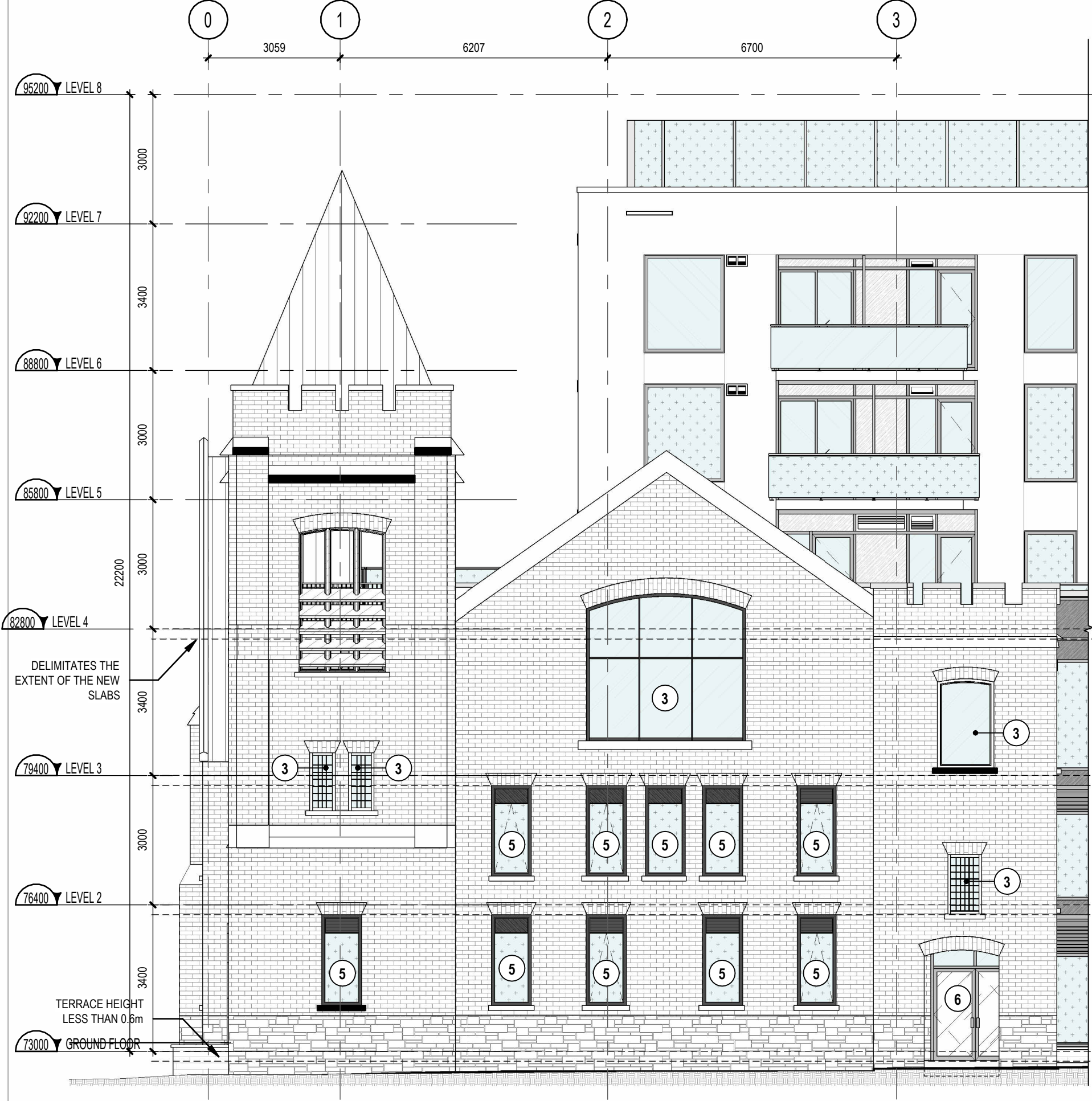
NEW WEST ELEVATION (BELL ST.)
