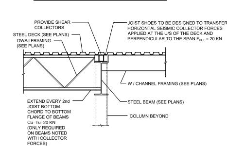
DETAIL: ROOF: BEAM / JOIST SUPPORTS
