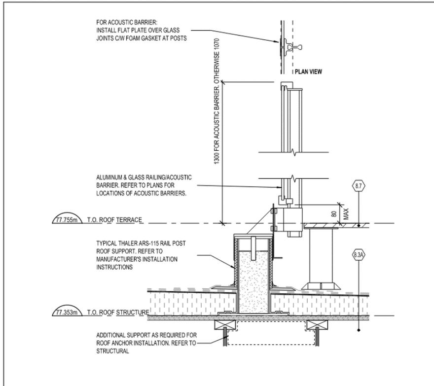
1 TYP. GLASS RAILING/ACOUSTIC BARRIER
