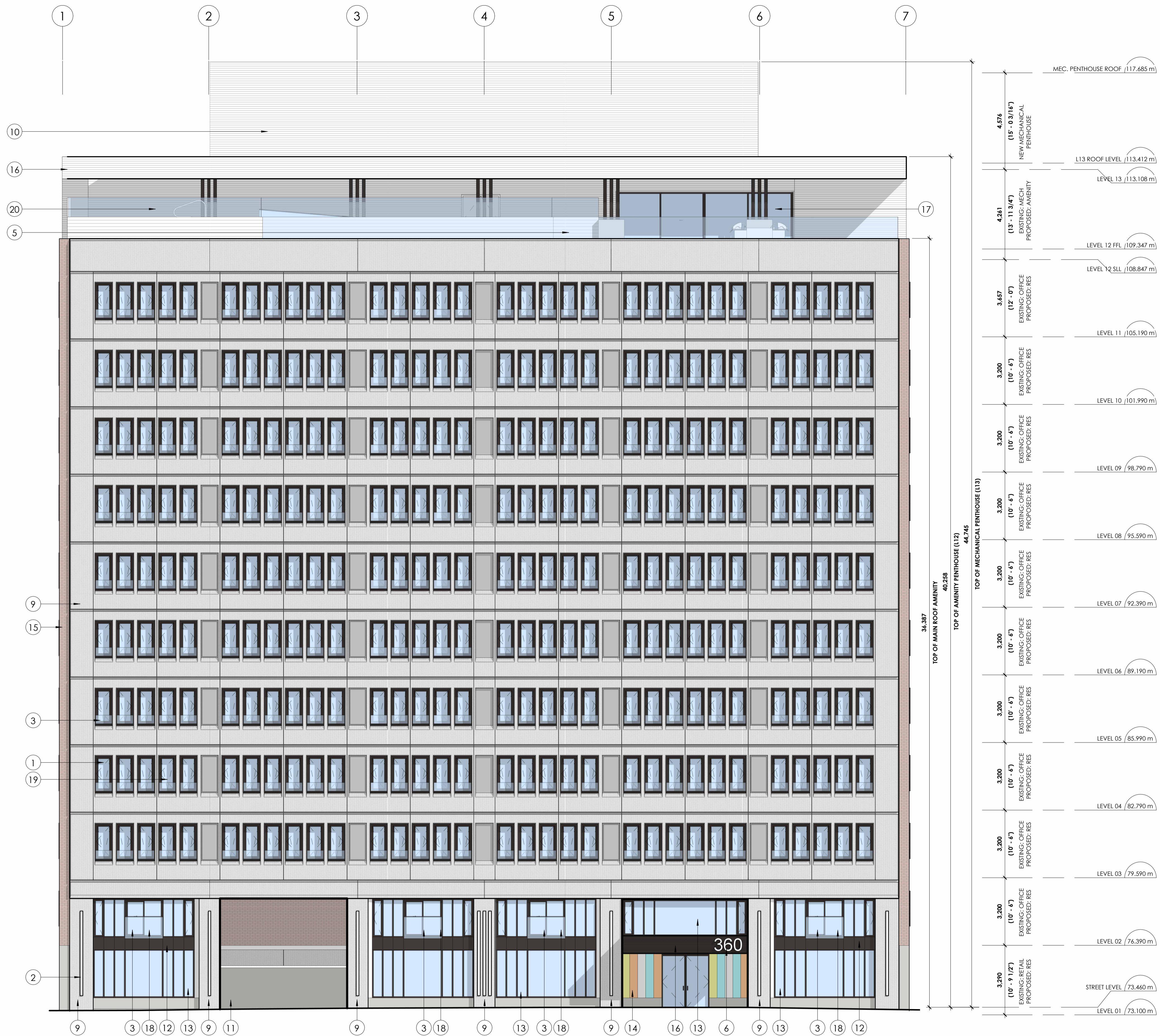
1 NORTH (LAURIER AVE W) ELEVATION A4-100 1:100
