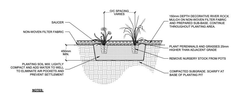
LOCATION OF PERENNIAL BEDS SPECIFIED ON DRAWINGS L.1 - L.5. PLANTING SOIL MIX AS PER SPECIFICATIONS. 4. PROVIDE 100mm HIGH EARTH SAUCER AROUND PERENNIAL/GRASS BED
