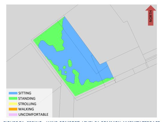
FIGURE 7A: SPRING – WIND COMFORT, LEVEL B1 COMMON AMENITY TERRACE
