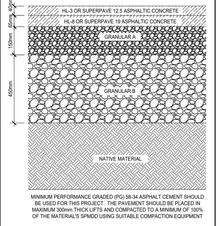
2 \ HEAVY-DUTY ASPHALT DETAIL
