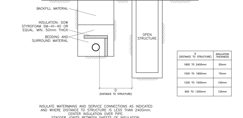
STAGGER JOINTS BETWEEN SHEETS OF INSULATION
