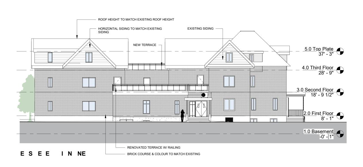
EXISTING BUILDING HEIGHT: 12.0m NEW ADDITION HEIGHT: 12.0m
