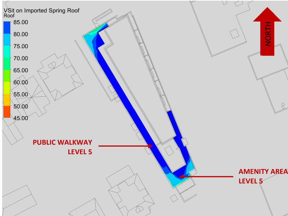
**FIGURE 7A: SPRING – PERCENTAGE OF TIME SUITABLE FOR SITTING – LEVEL 5 TERRACE**
