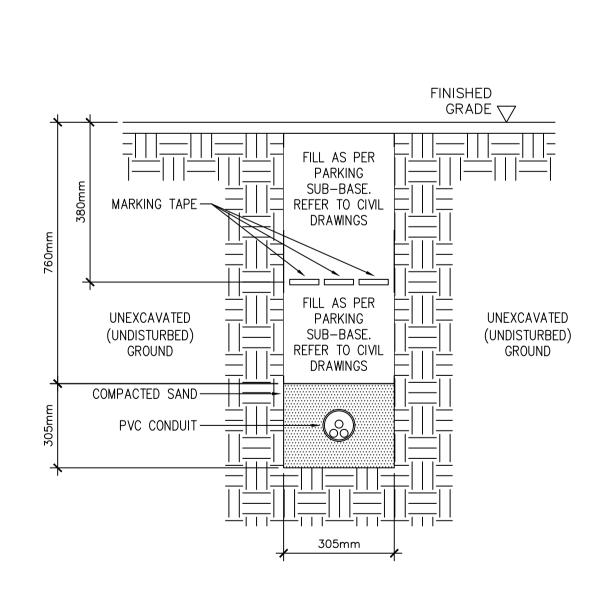
ELECTRICAL UNDERGROUND DETAIL - UNDER PAVEMENT
