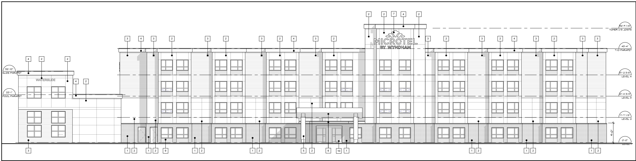
2 FRONT ELEVATION A2 SCALE: 3/32" = 1'-0"
